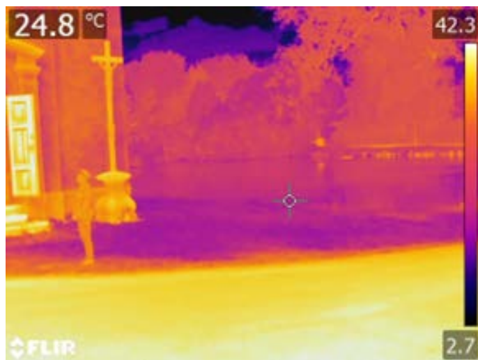
Obr. 1, 2: Termofotografie vyššího trávníku u kaple v Sedle (kolem 25 °C) a krátce posekaného trávníku naproti přes silnici (40 °C).
