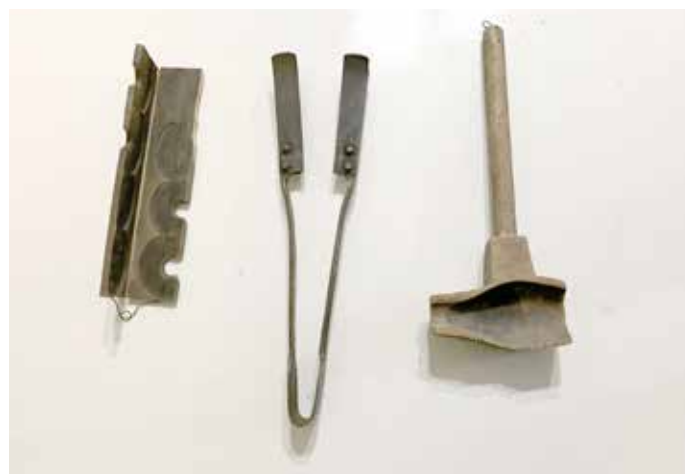
Klapačka, pacšál a burbulec (svalák) na přípravu skla před foukáním do formy
